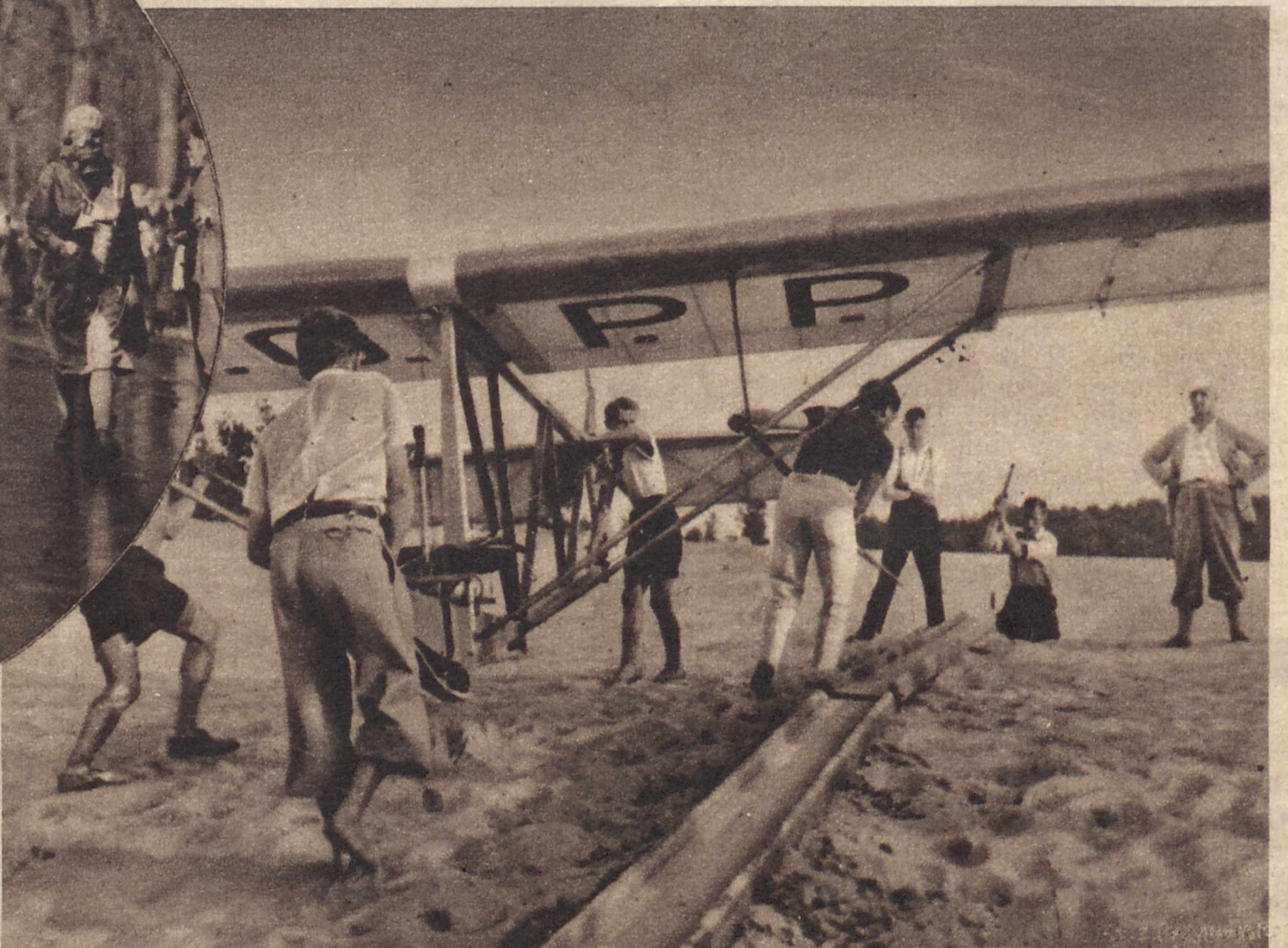
Dla zmniejszenia oporu przy starcie szybowców, ustawia się je w osobnym, z drzewo wykonanem łożu.
